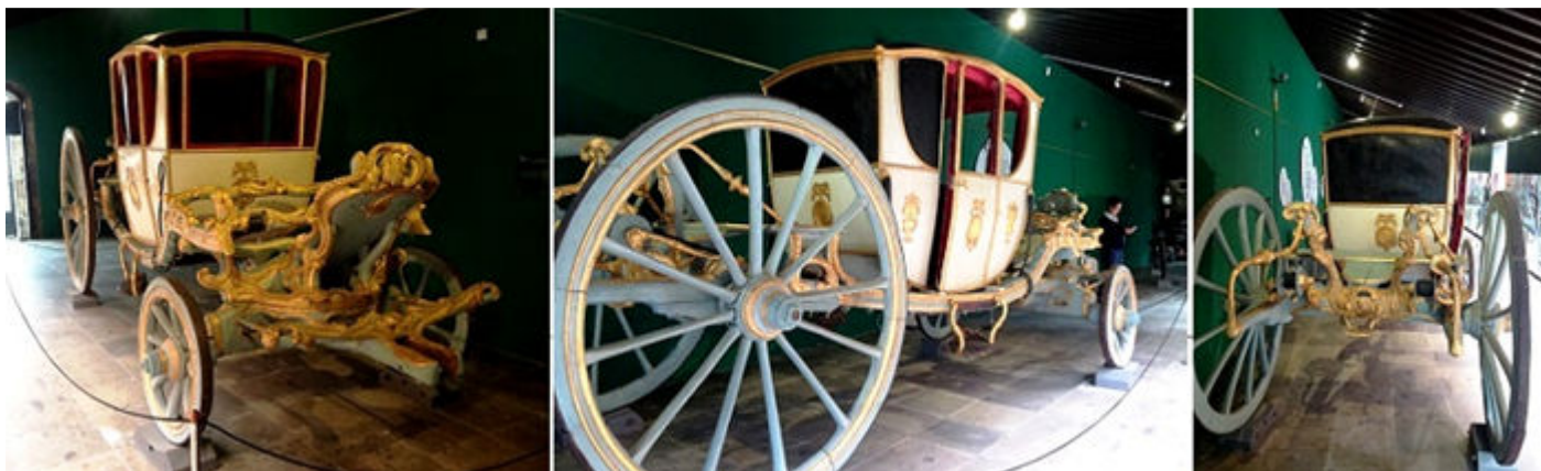
❶ Berlina del S. XVIII estilo rococó francés. ❷ Esta se caracteriza por poseer dos varas que unen ambos ejes del carruaje. ❸ Dispone de un carro o tren con un sistema de amortiguación, como se puede apreciar en esta parte trasera de la misma. Que mediante correas de piel, se suspende la parte superior. Es del carroceros francés L 'Deloche.
