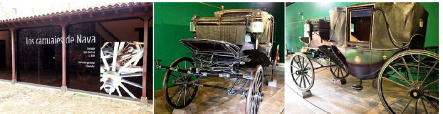
1 Cobertizo climatizado donde se encuentran los carruajes. 2 Landó del S. XIX, de taller inglés, donado por los descendientes de los Marqueses de Villanueva del Prado. 3 Considerado como vehículo de lujo en la época, enormemente cómodo y fue muy usado hasta principios del S. XX. Su principal característica es la doble capota situada detrás de cada uno de los asientos.
